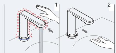
**Funcionamento:** Acionamento por aproximação das mãos em qualquer área do produto e encerramento automático entre 2 a 4 segundos após o afastamento destas
