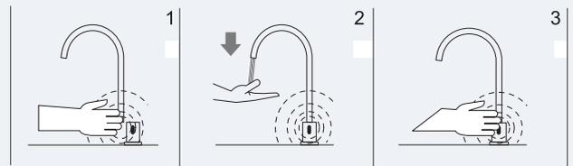
**Funcionamento:** Acionamento automático com a aproximação das mãos e encerra com nova aproximação ou após 90 segundos de funcionamento contínuo.
